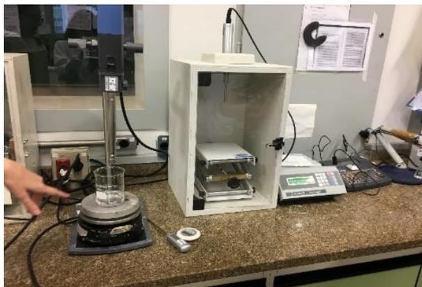
Figura 1 - Preparação das NLC utilizando homogeneizador de alta pressão (Ultra-Turrax®).
