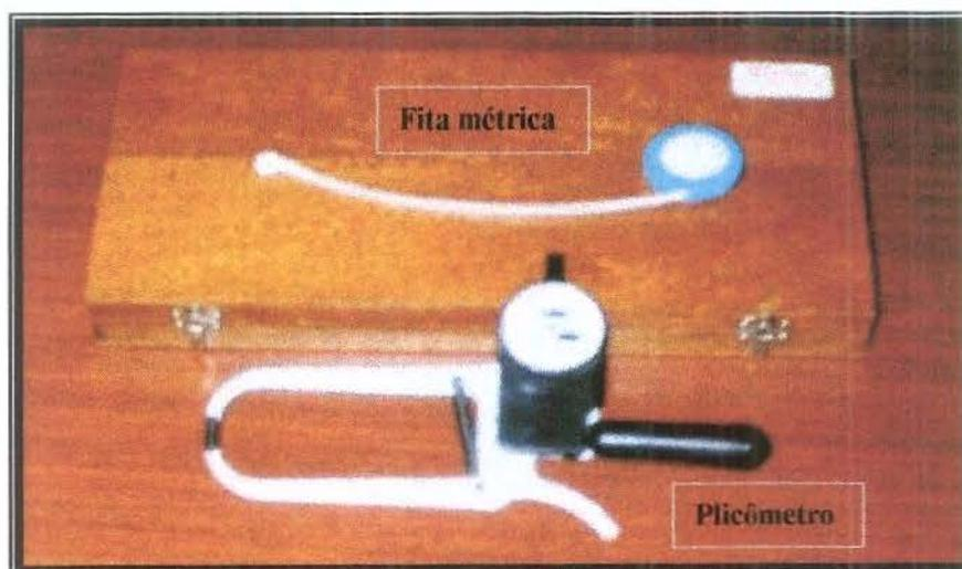
**Figura 4:** Aparelho utilizado para a avaliação das medidas de espessura de dobras cutâneas. Compasso de dobras cutâneas, também conhecido como Plicômetro ou Especímetro e fita métrica com escala de 0,5 cm para a medição das cirunferências.
