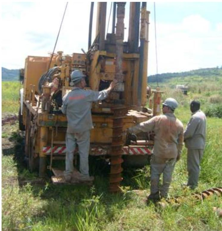
Figura 7. Processo de Amostragem Pitcher, com revestimento Denisson.
