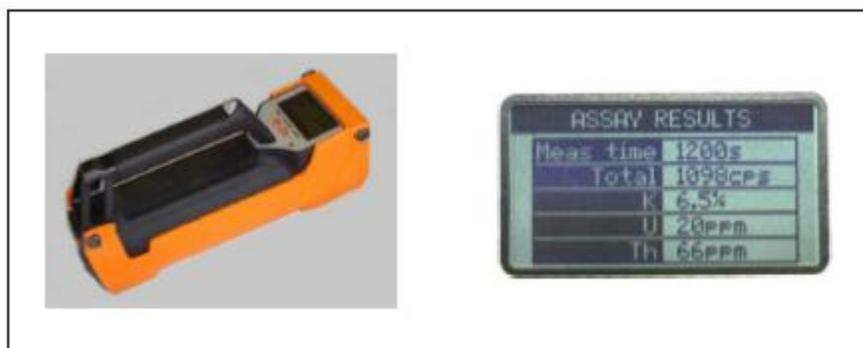
**Figura 10.** Gamaespectrômetro RS-230 utilizado neste trabalho.
