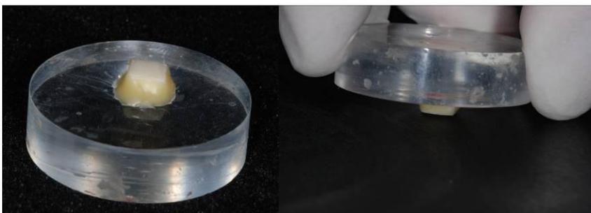
Fig. 3. Planificação da superfície de esmalte com lixas de carbeto de silício de granulação decrescente (#320, #600 e #1200).
