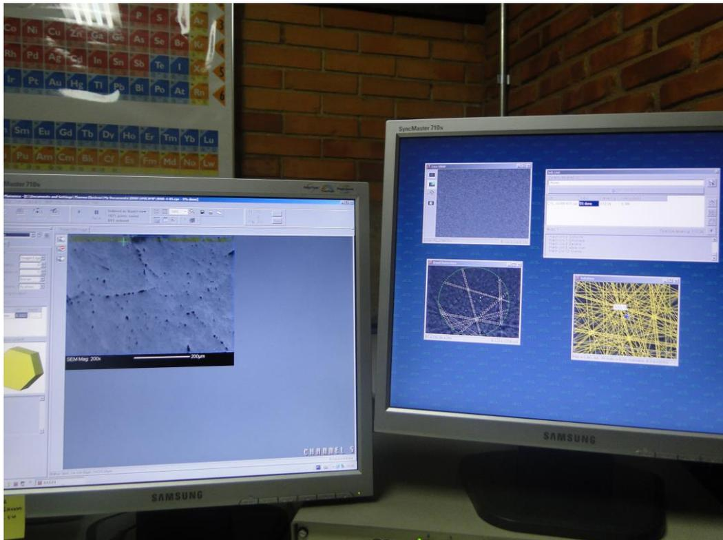
**Figura 4.** Mapeamento de quartzo com PDF decorado no EBSD-MEV. As linhas de Kikuchi são exibidas no monitor da direita.
