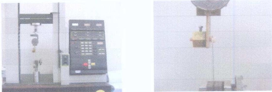
Figura 2 – Ensaio de resistência ao cisalhamento.
