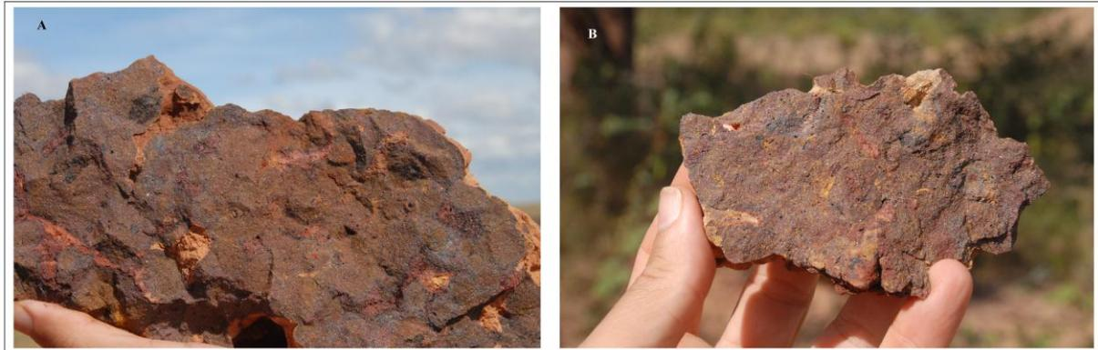
Figura 5.2 – (A) Coloração variada das lateritas encontradas. (B) Porções violetas indicando revestimento por óxido de manganês.
