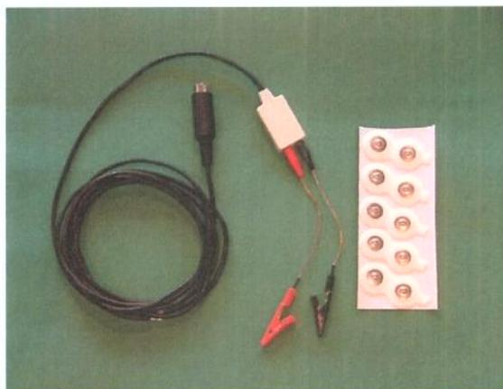
**Figura 1.** Eletromiógrafo DataHominis Tecnologia Ltda **Figura 2.** Eletrodos de superfície bipolares e cabos.
