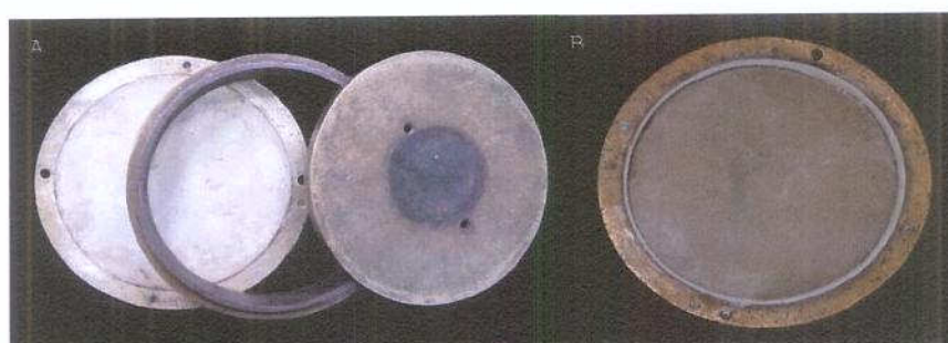
Figura 2 – Mufla metálica (A); Posicionamento da placa de vidro (B)
