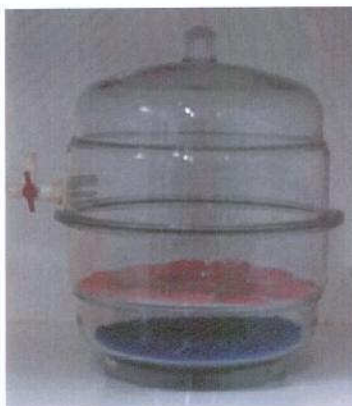
Figura 10 – Dessecador contendo os corpos de prova e sílica gel
