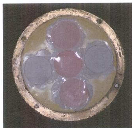
Figura 6 – Desinclusão dos corpos de prova
