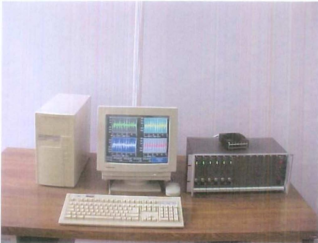
**Figura 6** - Eletromiógrafo da marca Lynx AI6010, contendo 6 canais, conectado ao computador para visualização dos registros no *software* Aqdados.
