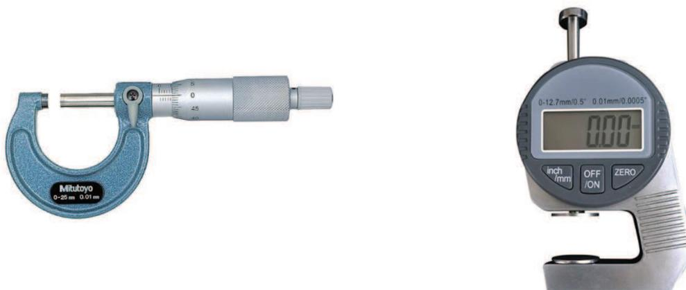
Figura 16: Instrumentos de medidas milésimais utilizados para aquisição dos dados manuais de diâmetro das amostras de raízes de cana-de-açúcar, utilizando micrometro ou especímetro.
