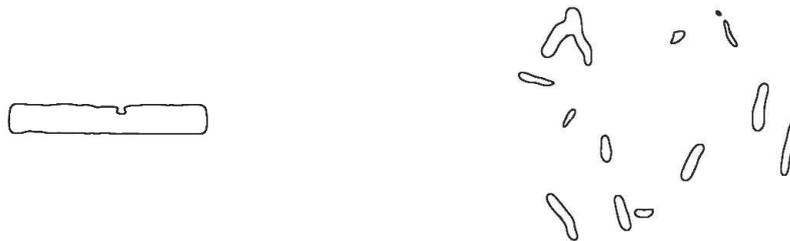
Figura 4: Imagem da régua e das raízes passadas pela função Measurements, responsável por isolar os objetos presentes na imagem realizando sua mensuração.
