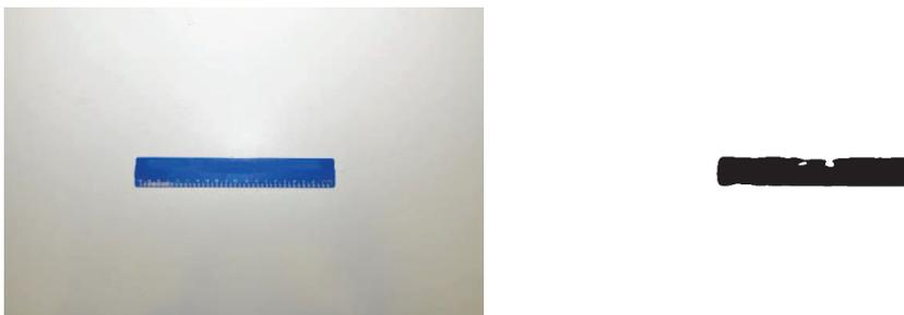
Figura 3: Processamento de imagens de uma régua através da função Threshold – conversão da imagem em escala de cor binária.
