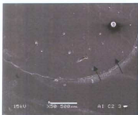
Figura 15. Exemplo de observação em maior aumento para qualificação da margem (50X). A seta indica
