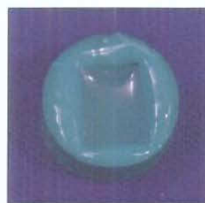
Figura 9. Molde vazado em resina epóxica para obtenção da réplica.
