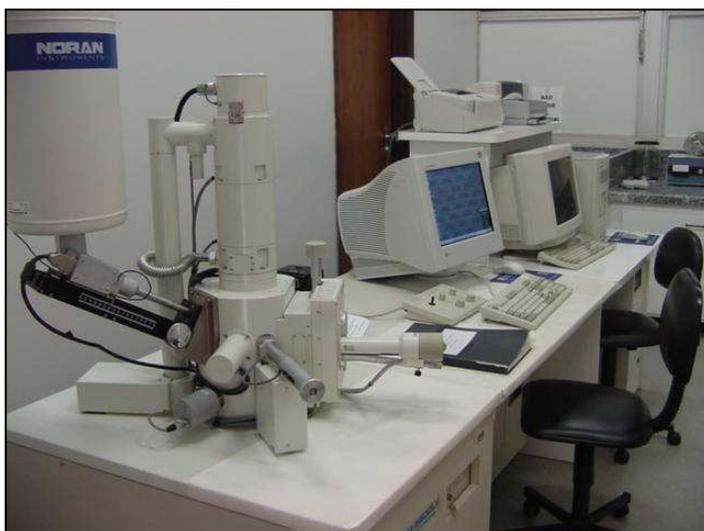
Figura 9. Microscópio Eletrônico de Varredura.
