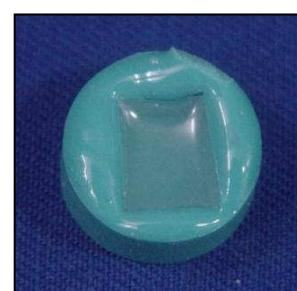
Figura 6. Molde vazado em resina epóxica para obtenção da réplica.
