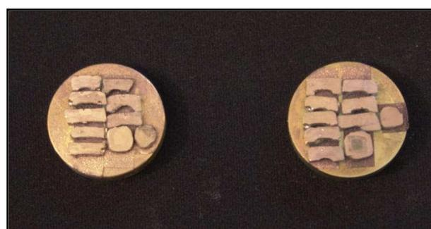
Figura 8. Réplicas metalizadas das amostras para avaliação em Microscopia Eletrônica de Varredura.
