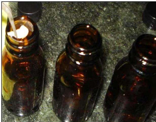
**Figura 3** - Polpa sendo colocada em frasco âmbar contendo solução de Hipoclorito de Sódio
