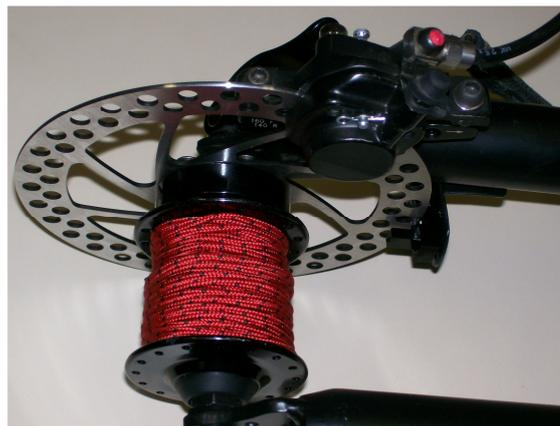
**Figura 10** Interação entre o fotomicrosensor, disco do freio, freio a disco e o cubo. Atuam na velocidade facilitando ou dificultando o deslocamento. Note os furos no disco do freio, eles que serão os responsáveis pela geração do sinal por parte do fotomicrosensor.
