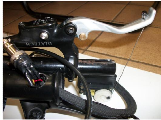
**Figura 9** Conexão entre o motor de passos e o manete.
