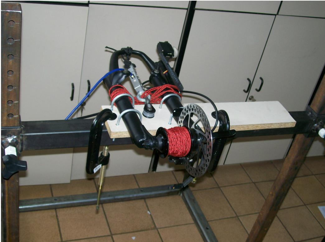
**Figura 11** Base de fixação do DMPES-A. Fixação com altura ajustável.
