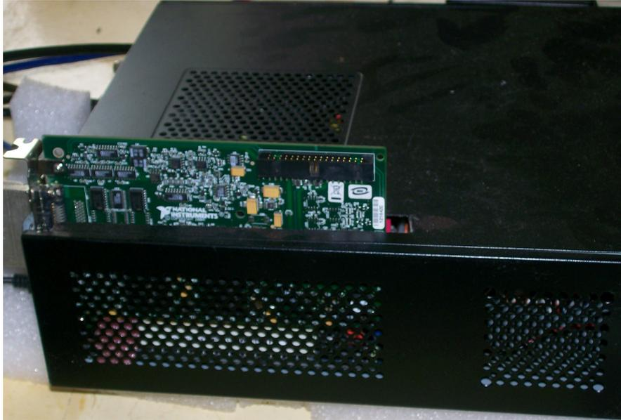
**Figura 15** Conversor A/ D. A placa armazena os dados que foram convertidos no conector em bloco de entrada/ saída.
