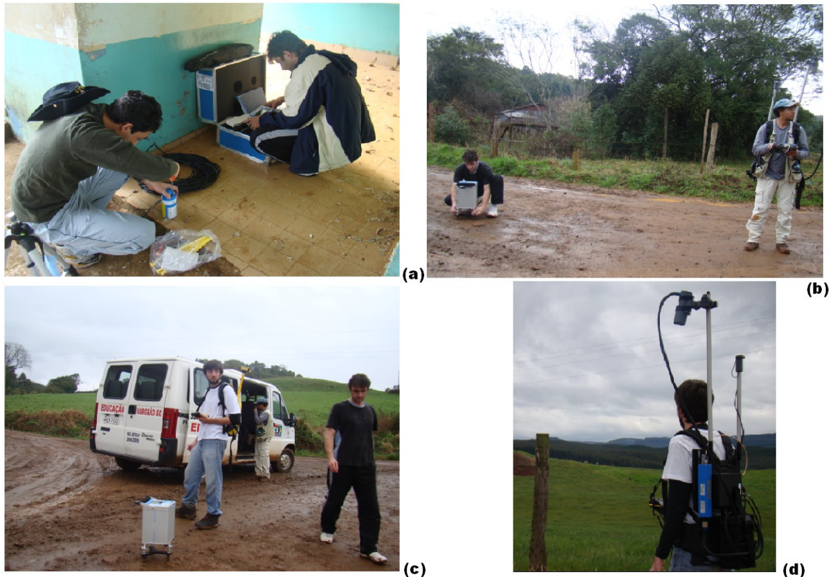
Figura 4.1 - a) Montagem do ENVI PRO na estação-base. b) Detalhe da utilização do gravímetro (esq.) e magnetômetro (dir.). c) Detalhe da utilização do GPS ao lado do gravímetro. d) Detalhe do magnetômetro CS-L .
