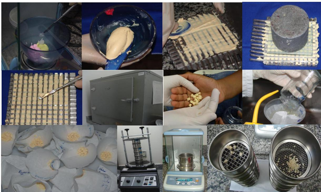
Fig. 2A. Método de avaliação da performance mastigatória com a utilização de material-teste (Optocal plus).
