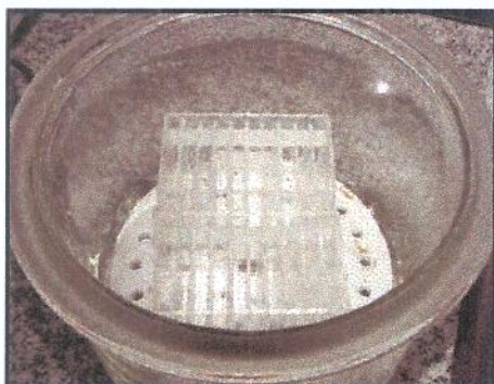
FIGS. 12 e 13 - Suporte contendo as amostras de acrílico no interior do dessecador contendo gel de sílica
