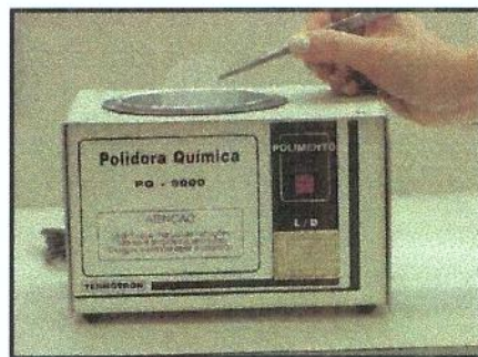
FIG.09 - Polidora química e amostra sendo submetida ao polimento
