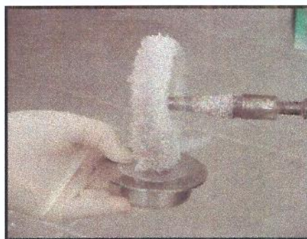
FIG.11 - Polimento com flanela e branco de Espanha
