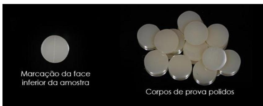
**Figura3.** Confecção dos corpos de prova
