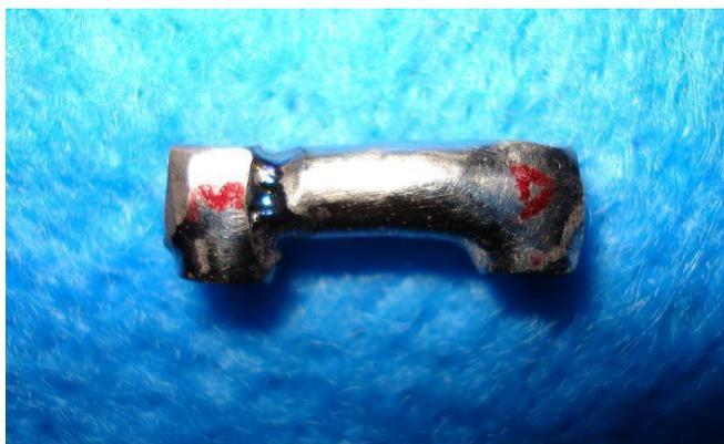
Figura1. Barra de titânio soldada a laser confeccionada para comparação entre as técnicas
