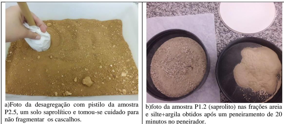
Figura 2.2.1: Fotos do procedimento de desagregação e das frações obtidas no peneiramento mecânico.
