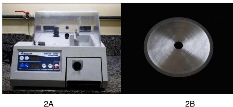
Fig. 2.A- Cortadeira metalográfica de precisão (Isomet 1000, Buehler, Illinois , EUA); B - Disco diamantado de alta concentração (4 "x 012 x 1/2, Buehler, Illinois, EUA).
