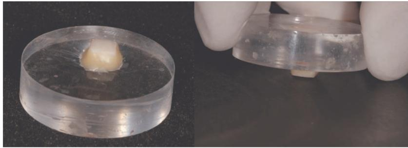
Fig. 3. Planificação da superfície de esmalte com lixas de carbeto de silício de granulação crescente (#600 e #1200).
