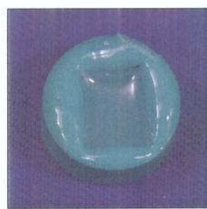
Figura 11. Molde vazado em resina epóxica para obtenção da réplica.
