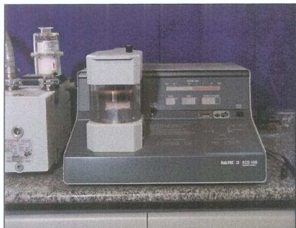
Figura 12. Metalizador Balzers-SCD 050 Sputter Coater, Liechtenstein
