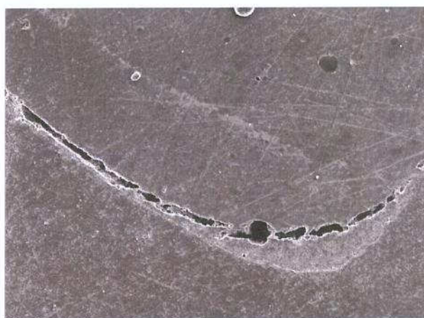
Figura 26. Fotomicrografia indicando a fenda formada entre o compósito restaurador e a camada de adesivo.
