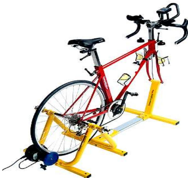
**Figura 1\_** Ciclossimulador CompuTrainer DYNAFIT™ (RacerMate®, Seattle, WA, USA) utilizado no  $TI_{max}$  e  $T_{const}$ .
