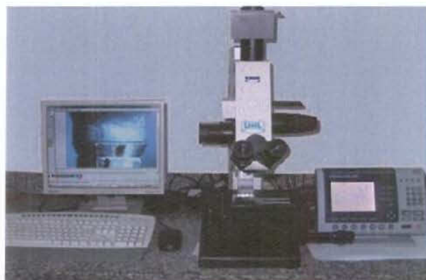
Figura 5. Microscópio óptico acoplado à unidade analisadora Quadra-chek
