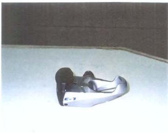
Figura 3.1: pedal de encaixe Exus Clip-in E-1 (compatível com Look).
