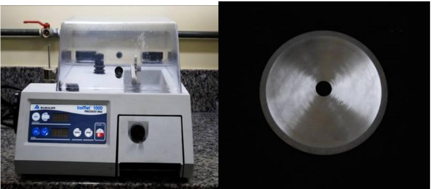
Figura 2: Cortadeira metalográfica e disco diamantado utilizados.
