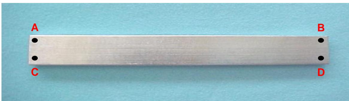
Figura 1 – Matriz metálica para confecção dos corpos-de-prova.
