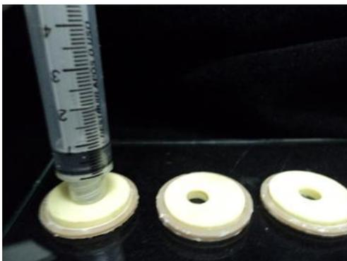
Fig. 2- Compósitos fluídos sendo inseridos no interior da matriz com o auxílio de uma ponta aplicadora de uma seringa cirúrgica em incremento único.
