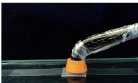
Fig. 9- Padronização da distância de fotoativação, o aparelho fotoativador LED Bluephase\* (Ivoclar Vivadent) foi posicionado o mais próximo possível da matriz de silicone, com a ponta do aparelho posicionada perpendicularmente à superfície do material.
