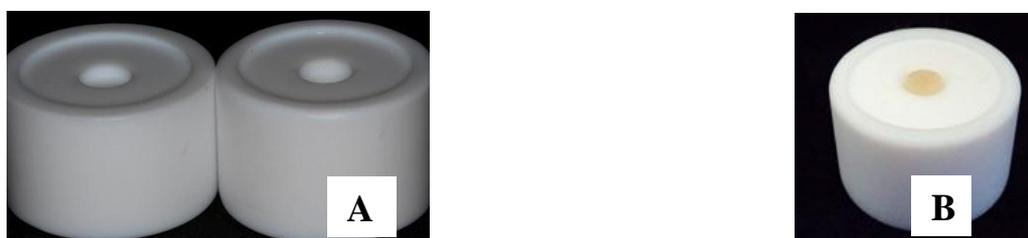
Fig. 22A- Porta-amostra confeccionado especialmente para o tamanho da amostra. B- Amostra posicionada no porta-amostra com o entalhe da identificação voltada para o operador.
