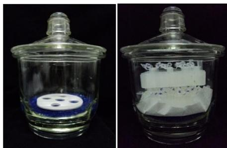
Fig. 12- Dessecador em sílica gel COD1911- 4mm (Dinâmica Química Contemporânea Ltda, Diadema, SP, Brasil), para remoção da água livre.
