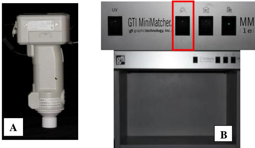
Fig. 23 A- Acoplamento da ponta de leitura do espectrofotômetro ao porta-amostra, evitando a entrada de luz externa. B- Cabine de luz (opção luz natural).
