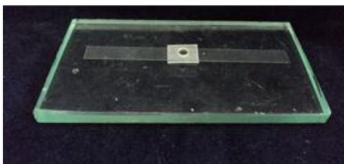
Fig. 7- Tira de poliéster (Dentsply, Petrópolis, Rio de Janeiro, Brasil) e uma matriz de silicone com dimensão padronizada de  $1,0 \pm 0,1\text{mm}$  de espessura e  $6,0 \pm 0,1\text{mm}$  de diâmetro interno.
