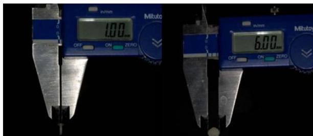
Fig. 14- Quatro aferições equidistantes da espessura dos corpos de prova através de um paquímetro digital. Após obtenção das medidas foi calculada uma média para mensuração do volume do corpo de prova.
