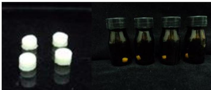
Fig.5- Os corpos de prova foram retirados da matriz e armazenados em potes de cor âmbar, sendo os mesmos identificados para cada tipo de material durante 24h, para a completa polimerização.
