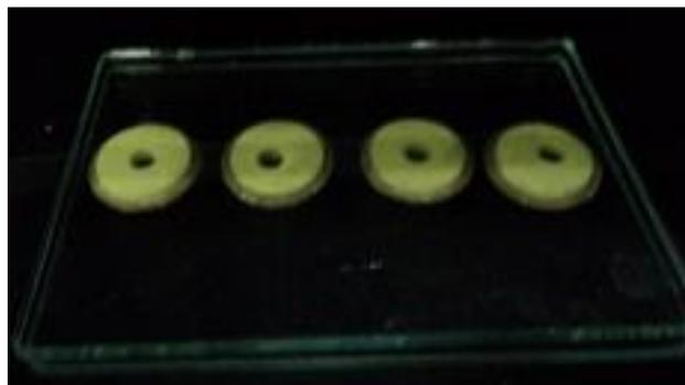
Fig. 1- Tira de poliéster (Dentsply, Petrópolis, Rio de Janeiro, Brasil) e uma matriz de silicone com dimensão padronizada de  $1,0 \pm 0,1\text{mm}$  de espessura e  $6,0 \pm 0,1\text{mm}$  de diâmetro interno.
