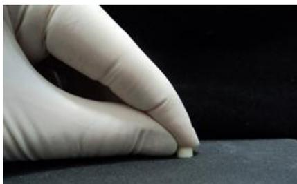
Fig. 6- Após 24h as amostras foram polidas com lixa de granulação média para remoção dos excessos laterais.
