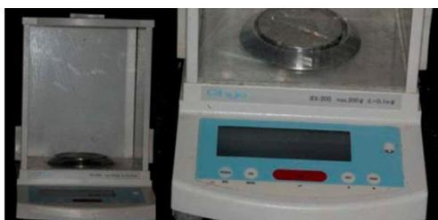
Fig. 13- Balança analítica de alta precisão Chyo JEX-200(YMC Co, Ltd, Toquio, Japão)
