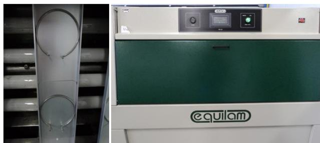
Fig. 19A- Placas fixadoras na **A** câmara de condensação frente à fonte de luz. **B** lâquima de simulação de ciclos térmicos (ensaio de envelhecimento acelerado (intemperismo natural EQ-UV)).
