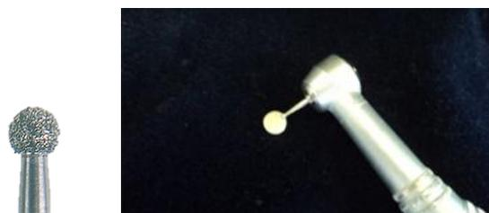
Fig. 21- Espécime recebendo marcação com broca esférica (KG Sorensen) em uma das faces laterais com a finalidade de padronizar o posicionamento da amostra.
