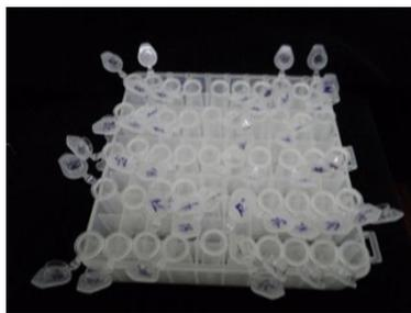
Fig. 11- Corpos de prova foram colocados em *ependorfes* de 1,5ml devidamente certificados com o nome de cada material.
