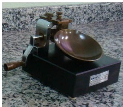
Figura 2 - Aparelho de Casagrande, utilizado para a obtenção do limite de liquidez (LL). Foto: UDESC – DEC.
