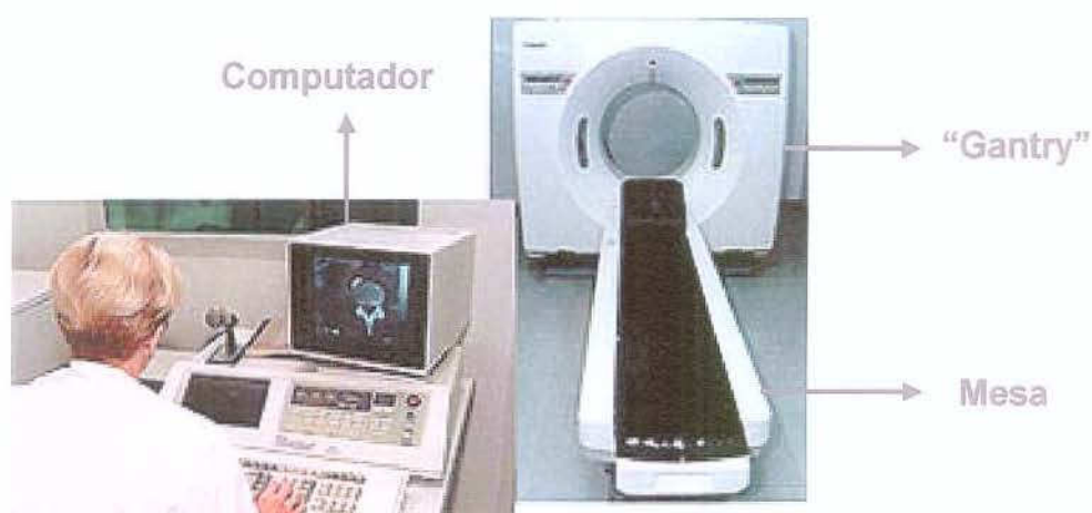
FIGURA 2 – Constituição do Tomógrafo Computadorizado (TC)
