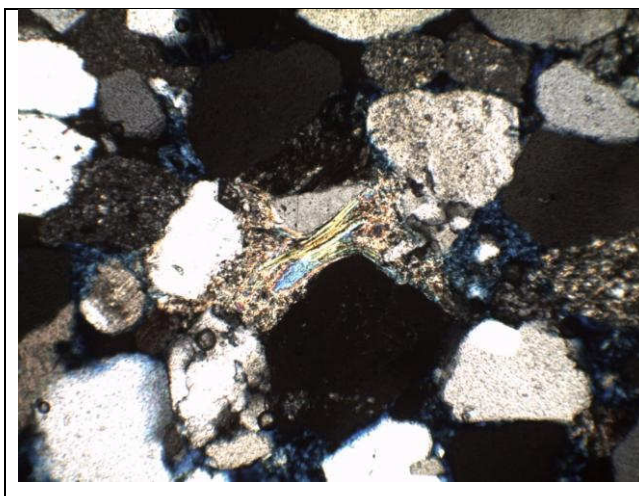
Figura 3.11: Fotomicrografia evidenciando compactação mecânica, muscovita deformada por grão de quartzo (10x-LPA).
