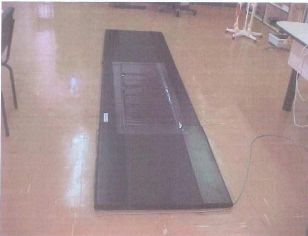
**Figura 22:** Plataforma modular com sensores do baropodômetro eletrônico.
