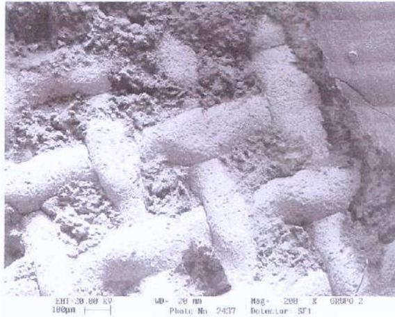
Figura 7 – Aspecto fotomicrográfico (MEV) do bráquete após remoção mostrando a resina composta Concise Ortodôntico entre as malhas (X 200).
