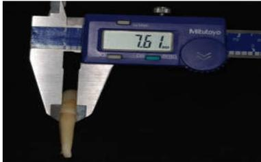
Figura 3. Paquímetro medindo o tamanho das raízes na distância vestibulo-lingual e méso-distal.
