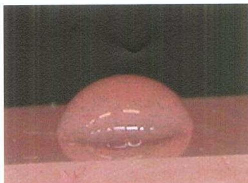
**Figura 7:** Imagem da gota séssil capturada por uma máquina digital para mesurar o ângulo de contato
