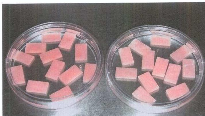
**Figura 9:** Espécimes imersos em saliva clarificada para formação de película adquirida
