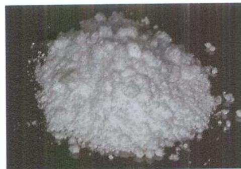
**Figura 2:** PTFE micro-particulado adicionado à resina
