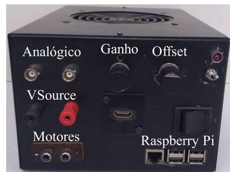
(b) Montagem física do dispositivo de interface
