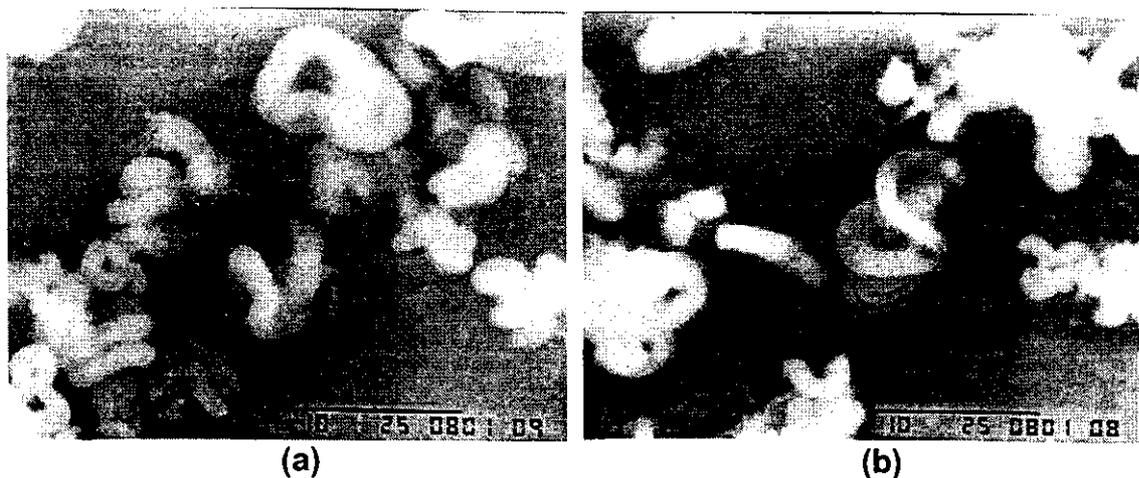
Figura 17: Micrografias de Cr-MCM-41 obtida pelos métodos 2 (a) e 4 (b).
