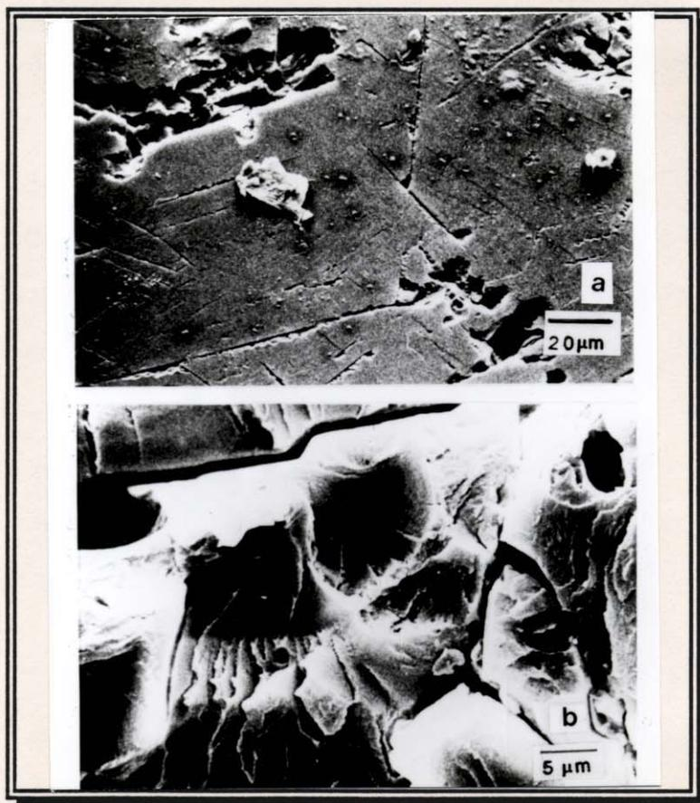
Fig. 4 - Micrografias eletrônicas de varredura de fraturas em PMMA após o impacto de gotas de água (diâmetro 1,2mm) a uma velocidade de 400 m/s. a) Observa-se nesta fig. esfarelamento conchoidal na superfície de PMMA. b) A fig. mostra que o impacto das gotas causou fratura frágil em PMMA e muitas lascas foram desprendidas do material (88).
