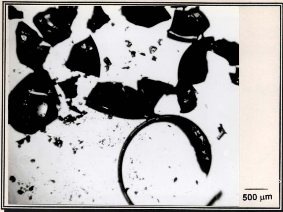
Fig.26 - Micrografia ótica de partículas de resina Lewatit S-100 após contato com 200 ml de CPC 4,0 mM a 25 C sob agitação a 25 rpm por 24 horas.
