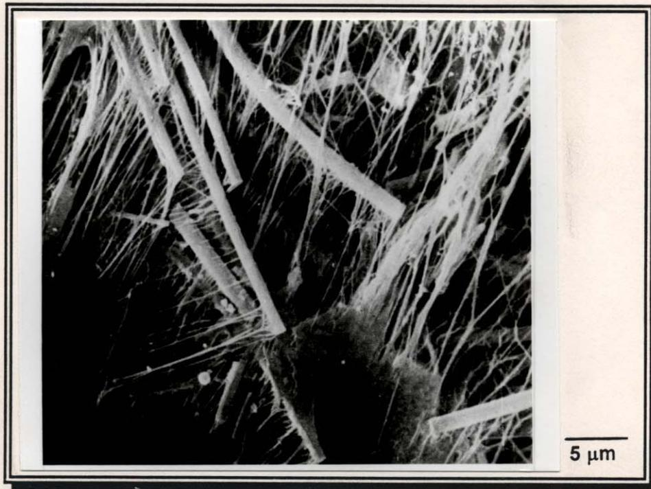
Fig. 3 - Micrografia eletrônica de varredura de fratura dúctil em fibra de vidro reforçada com PTFE. A fig. mostra o grande estiramento do material e sua excelente adesão nas fibras de vidro (88).
