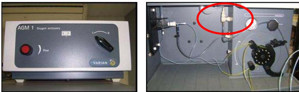
**Figura 4:** AGM-1 (esquerda) e no detalhe (à direita) o dispositivo de entrada de oxigênio no plasma.
