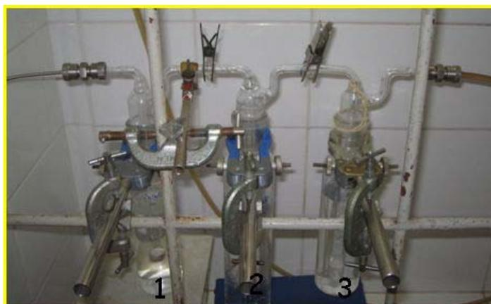
**Figura 3.4:** Detalhe dos lavadores de gás para absorção do  $H_2S$  excedente contendo soluções de (1)  $Zn(NO_3)_2$ , (2)  $NaOH$  e (3)  $Zn(NO_3)_2$
