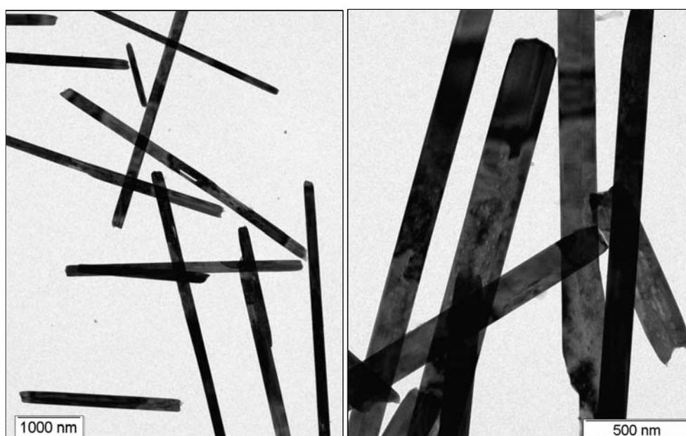
**Figura 4.41:** Imagens TEM dos nanobastões preparados em autoclave de 45 mL.
