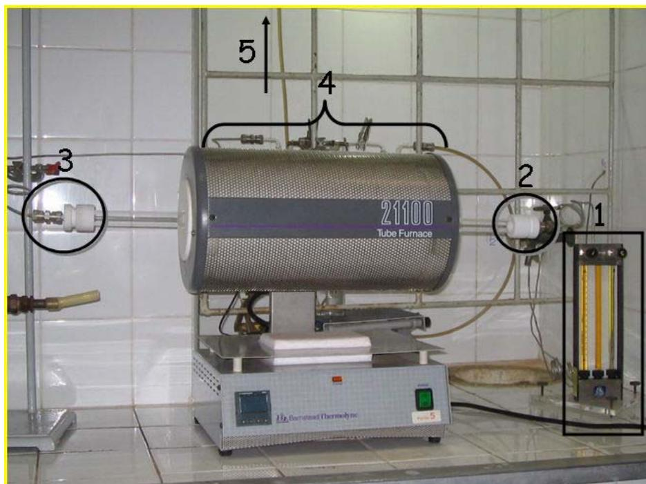
**Figura 3.3:** Foto do sistema montado para reação gás-sólido: (1) Medidores de fluxo e misturador de gás; (2 e 3) Conexões em aço-teflon-quartzo para entrada e saída dos gases do forno, respectivamente; (4) lavadores de gás e (5) saída dos gases.
