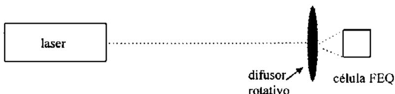
**Figura 7.1:** Sistema óptico para ataque FEQ com luz monocromática utilizando um difusor rotativo para quebrar a coerência do feixe sem a introdução de manchas.
