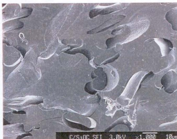
Figura 61 - Micrografia eletrônica de varredura do compósito C/SiC<sub>x</sub>O<sub>y</sub>F<sub>3</sub> (aumento de 1000X).
