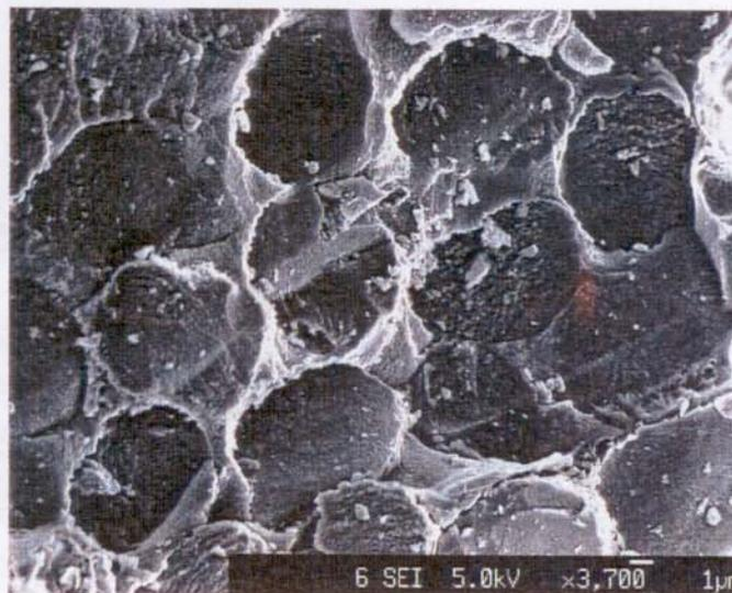
Figura 50 - Micrografia eletrônica de varredura do compósito C-C/SiC<sub>x</sub>O<sub>y</sub> 1350°C (aumento de 3700X).
