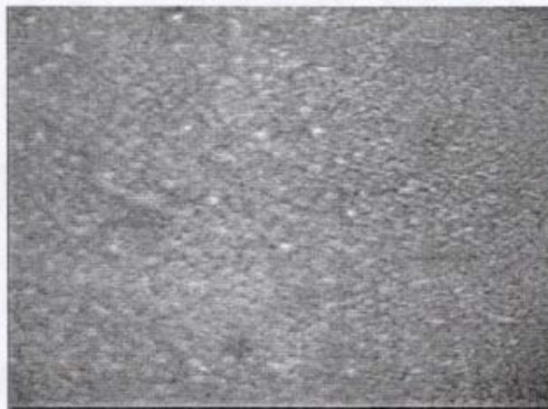
Figura 25: Imagem de um padrão de HIPS/PPO com 30% de HIPS e 70% de PPO.
