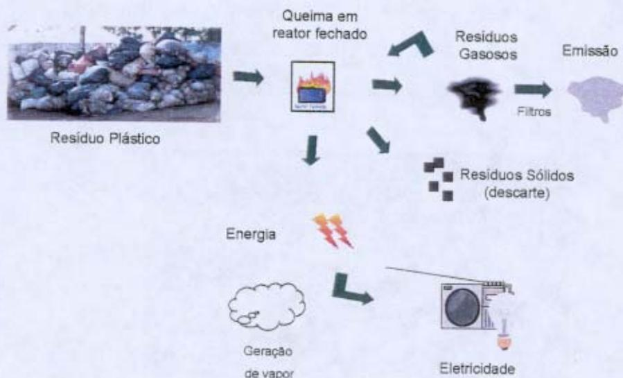
Figura 1.5: Representação esquemática da reciclagem energética
