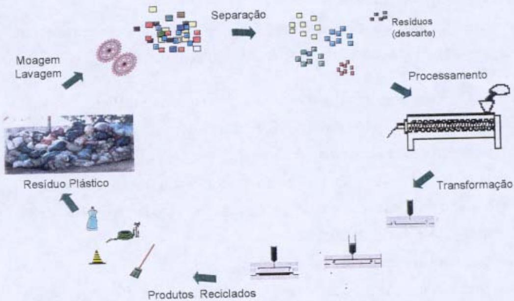
Figura 1.3. Representação esquemática da reciclagem mecânica.
