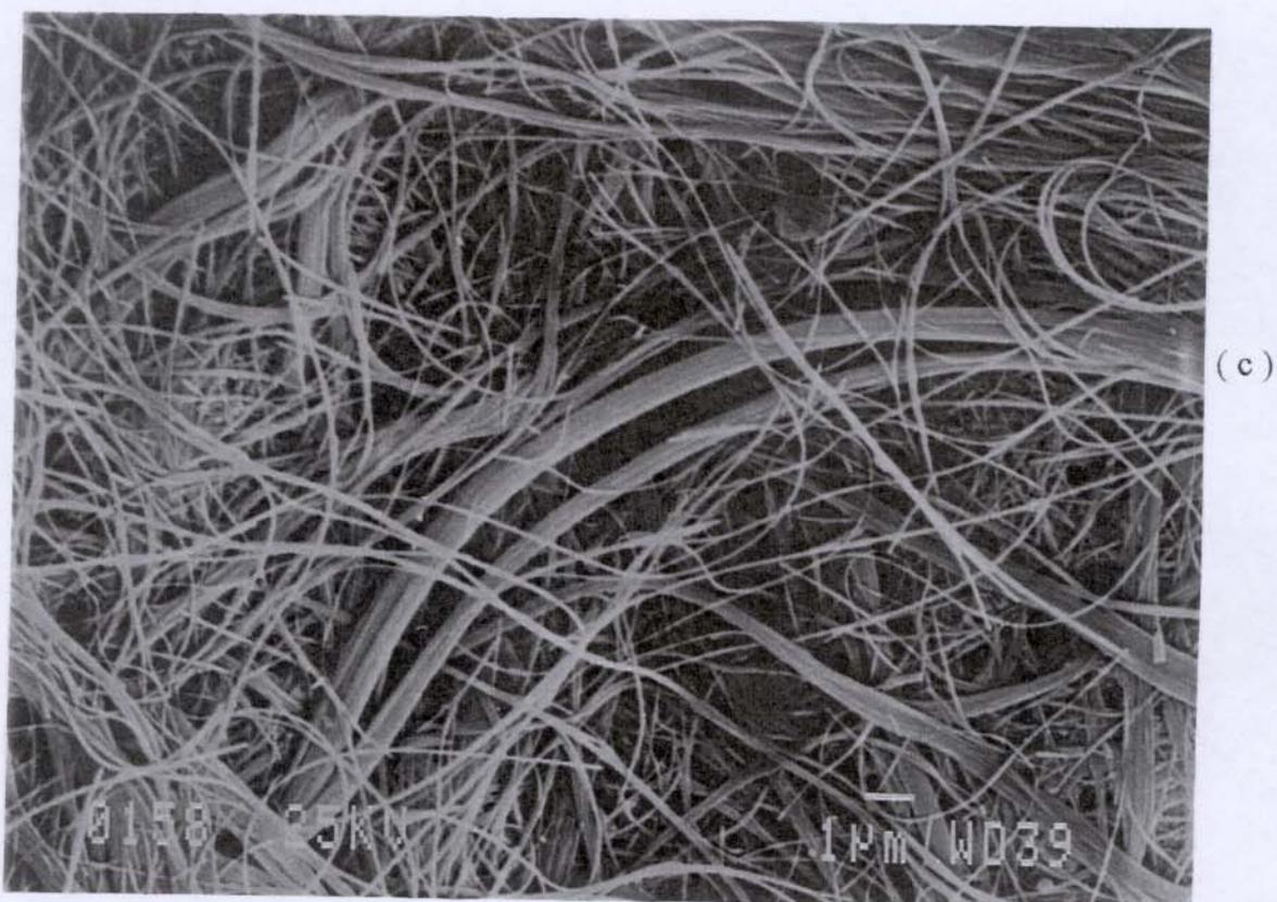
**Figura 31 c):** Micrografia eletrônica de varredura da crisotila tratada no reator ar/tampão/1h.
