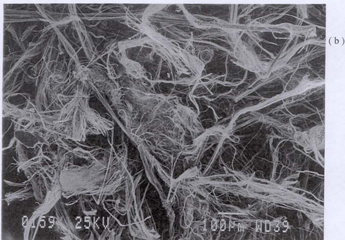
**Figura 30:** Micrografias eletrônicas de varredura da crisotila: a) tratada no reator CO<sub>2</sub>/água/1h; b) tratada no reator ar/tampão/1h.
