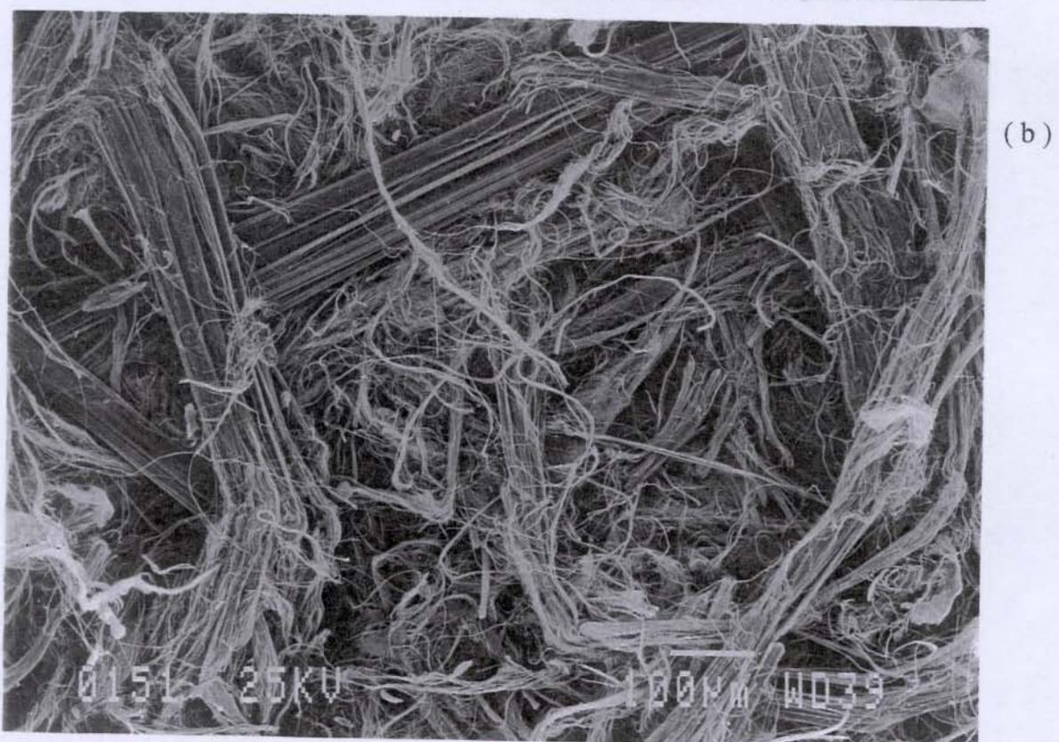
**Figura 29:** Micrografias eletrônicas de varredura da crisotila: a) jateada; b) tratada no reator CO<sub>2</sub>/água/5h.
