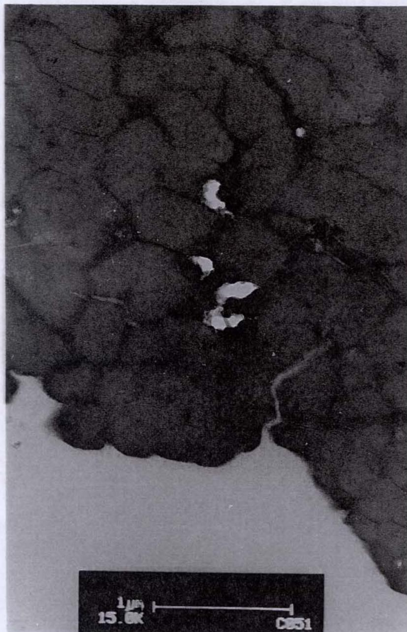
Figura 24: Micrografia eletrônica de transmissão de um outro local da seção transversal do fio Oxi.controle. Oxidação realizada com uma mistura de  $H_2O_2$  20 volumes, persulfato de potássio e  $NH_4OH$  em contato com as fibras por 30 minutos a  $32^\circ C$  Aumento de 45000x.
