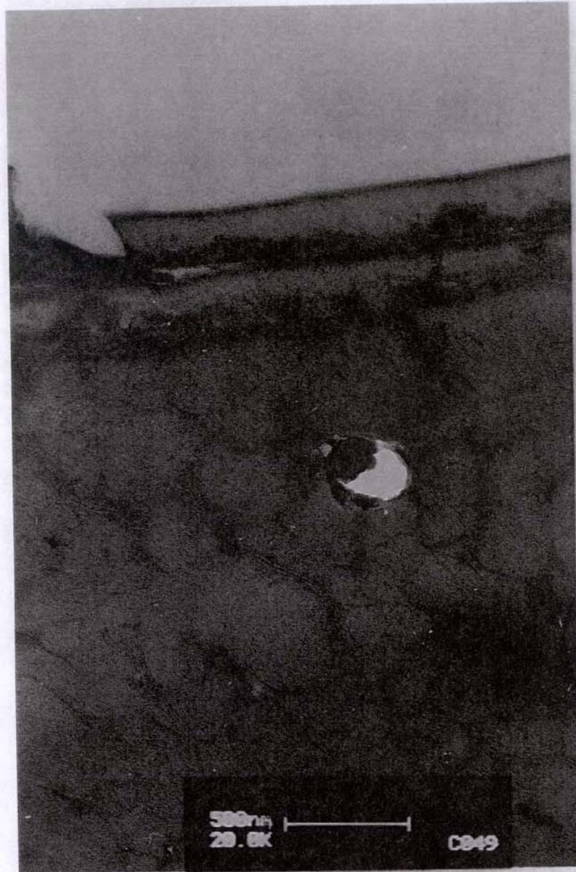
Figura 23: Micrografia eletrônica de transmissão da seção transversal de um fio Oxi.control. Oxidação realizada com uma mistura de  $\text{H}_2\text{O}_2$  20 volumes, persulfato de potássio e  $\text{NH}_4\text{OH}$  em contato com as fibras por 30 minutos a  $32^\circ\text{C}$ . Aumento de 60000x.
