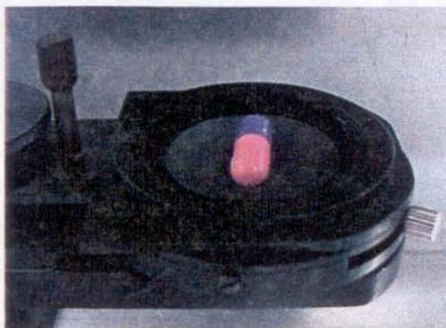
**Figura 52.** Foto do suporte de amostra adaptado para a obtenção do espectro de refletância do medicamento na forma de cápsulas.
