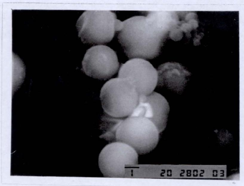
Figura 88. Micrografia eletrônica de varredura de AlTi. A barra de escala é dada em micrômetros.
